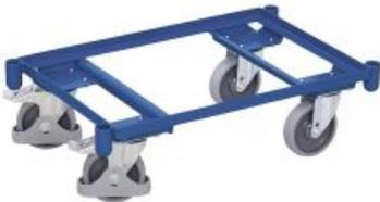
Carro de metal 675x415x205mm con 4 ruedas, 2 con frenos y protección para los pies. La superficie de carga es de 605x410 mm y es adecuada para contenedores estándar europeos. La capacidad de carga de esta plataforma es de 250 kg.
