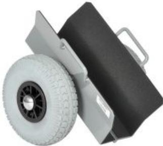
Carretilla robusta y rodillo de placa de Matador con núcleo negro y banda de rodadura gris claro hecha de PU a prueba de pinchazos. El diámetro de la rueda es de 260 milímetros. Las dimensiones de la abrazadera son 390 x 125 x 206 mm. Este rodillo de placa tiene su propio peso de 7 kg.
