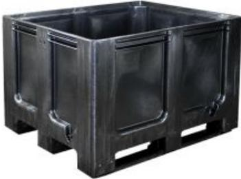
Paletbox de plástico con 3 patines, hecho enteramente de material reciclado de plástico. Las paredes y el fondo de la caja están cerradas. Las dimensiones externas son las dimensiones 1200x1000x760mm e interior: 1115x915x600mm. La capacidad es de 610 litros.
