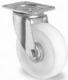
Rueda giratoria con núcleo de PP blanco y banda de rodadura con rodamiento de rodillos. El diámetro de la rueda fija es de 108 mm y tiene una capacidad de carga de 150 kg.
