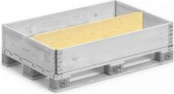
Con este divisor en el lado largo, puede crear 2 compartimentos dentro de un collar de palets en muy poco tiempo. El tamaño del tabique múltiple es de 1150x9x195 mm. El muro está provisto de una serie de ranuras, dependiendo de la división deseada.
