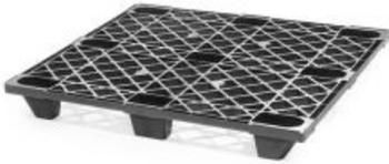
Palet de plástico con las dimensiones 1200x1000mm. El palet es anidable y tiene una cubierta inferior que consta de nueve patas y una cubierta superior cuadrículada.
