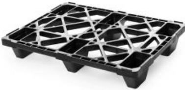
Palet de plástico pesado para expositor encajable con plataforma abierta hecho abierto completamente de plástico PO. Tiene una capacidad de carga dinámica de 1000kg y una capacidad de carga estática de 2500kg. Las dimensiones son 800x600x130mm.
