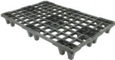
Palet ligero encajable de plástico 1200x800x138mm para exportación con 24 apoyos y está provisto de un borde elevado. Este palet tiene una capacidad de carga de estática 1600kg y una capacidad de carga dinámica de 900 kg.
