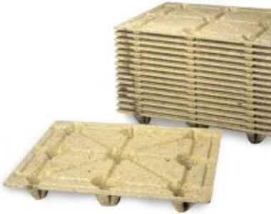
Palets de conglomerado anidables y encajables con una construcción extra fuerte. Compatible con carretillas elevadoras y transpaletas de 4 lados. Su capacidad de carga es de 1250kg y dimensiones de 1200x1000x135mm.
