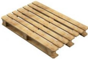
Palet químico CP2 con dimensiones 1200x800x138mm. Capacidad de carga de hasta 1000kg. Palet equipado con 3 patines y 7 tablas.
