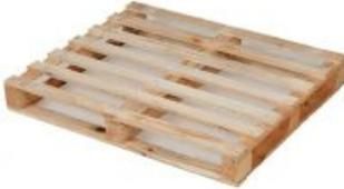
Este palet de servicio mediano tiene las dimensiones 1200x1000x146mm. El palet tiene una carga máxima de 750 kilogramos. Esto hace que la paleta sea adecuada para cargas de peso ligero a medio.
