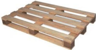
Este pesado palet de madera tiene una capacidad de carga máxima de 1000 kilogramos. El palet tiene las dimensiones 1200x800x155mm. El palet tiene 5 tableros superiores, 3 estantes intermedios y 3 patines de base.
